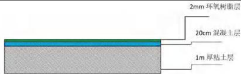
图2.3-1 防渗施工剖面示意图
